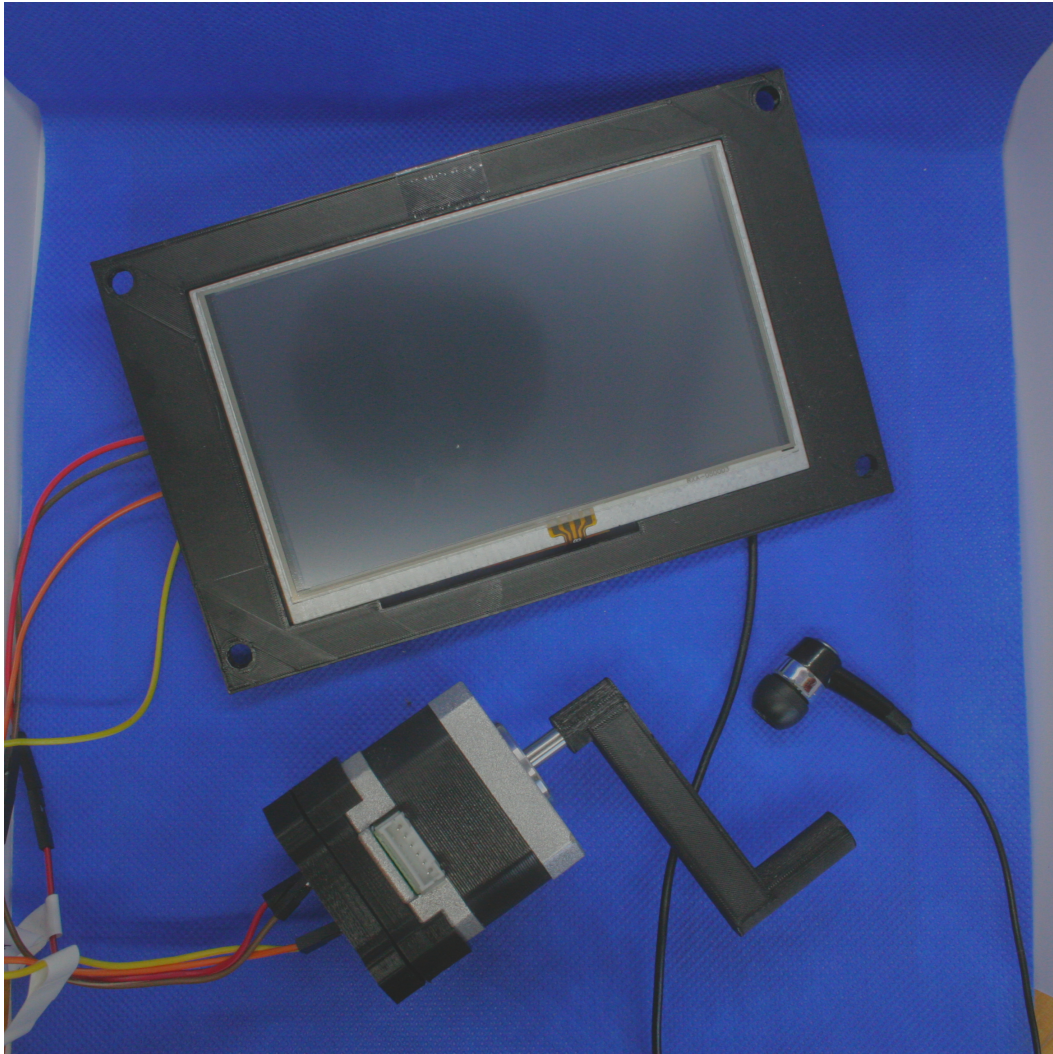
Écran tactile , 5 pouces (13 cm en diagonale), Résolution : 800 x 480.
